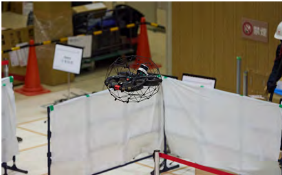
市販ルーツ活用分科会のドローンWGによる3次元測量ドローンのデモ
